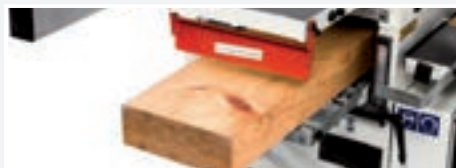
● Regruesadora con capacidad hasta 90 mm (altura)
