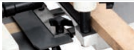
● Tupi horizontal. Permite realizar galces y rebajes
